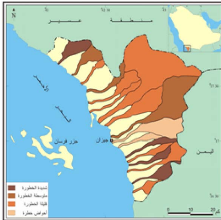
شكل (٢٨): احتمالية حدوث السيول وتغذية خزانات المياه الجوفية وفقا لمعدل التفرع وتكرار المجاري بأودية منطقة جازان
